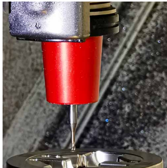
在硬材加工过程中，通过MHT介质分配器供应润滑剂（照片：Klaus Vollrath）
