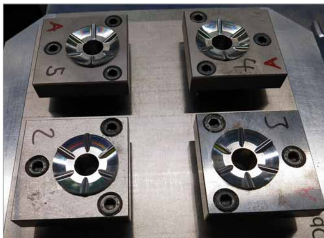
在设置区域，工件被夹紧在托盘上（照片：Klaus Vollrath）
