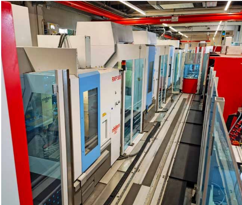
ZF的硬加工定时生产线包括四台Rödgers加工中心和一台坐标测量机。电火花线端口位于轨道的末端（照片：Klaus Vollrath）
